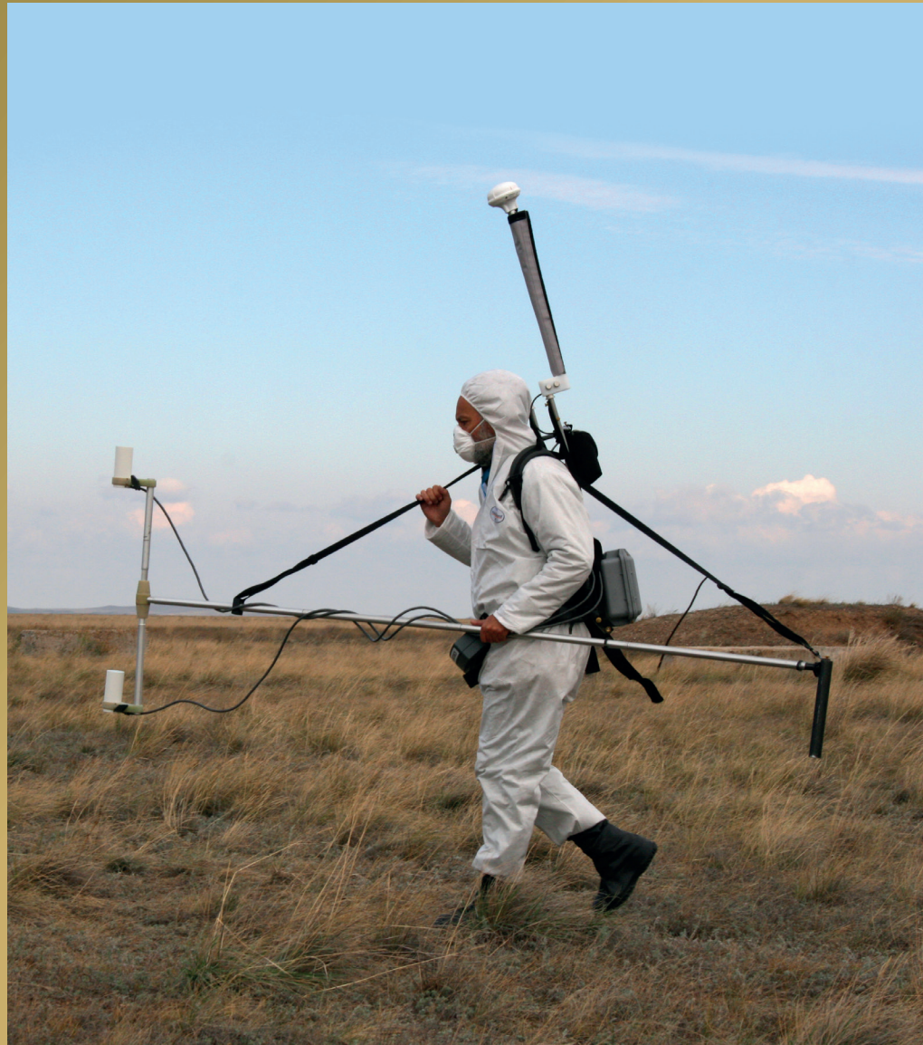
مفتش موقعي مختص يحمل مقياساً للمغناطيسية، وهو أداة تقيس الانحرافات في المجال المغناطيسي للأرض وتساعد على تحديد التجاويف التي قد تكون ناجمة عن انفجار نووي تحت الأرض
